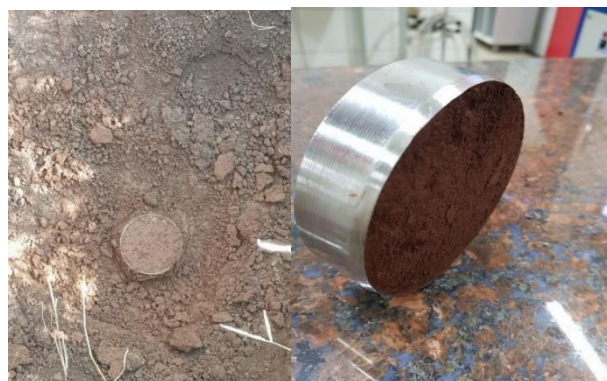
Figura 4. Coleta de amostra em campo e preparada para ensaio de adensamento em laboratório
