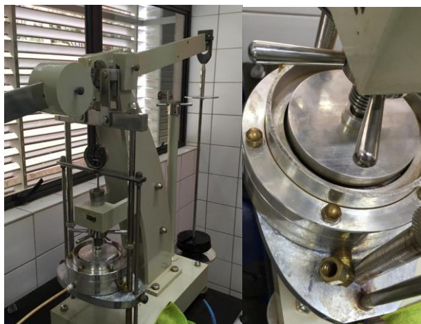
Figura 3. Ensaio de adensamento sendo realizado
