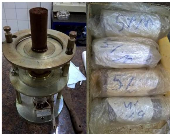
Figura 3. Extração e armazenamento de corpos de prova
