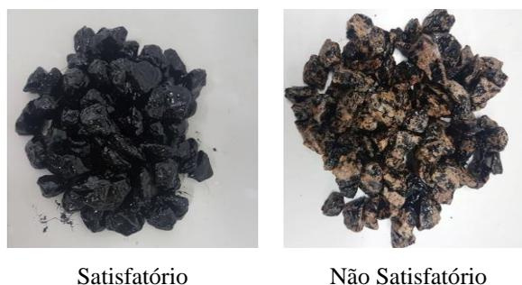
Figura 3 - Amostra de mistura asfáltica após ensaio de adesividade do agregado graúdo
