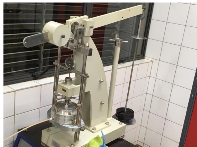
Figura 3. Ensaio oedométrico sendo realizado
