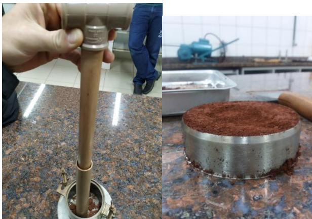
Figura 2. Soquete utilizado e amostra compactada
