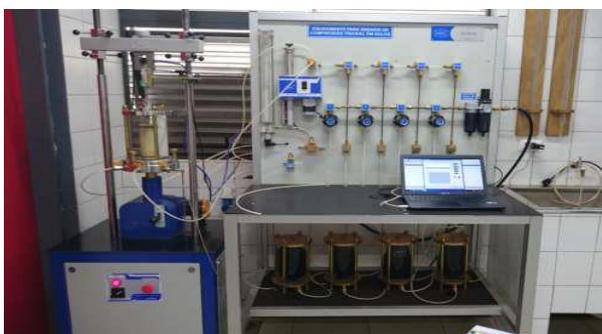
Figura 4. Equipamentos utilizados no ensaio de compressão Triaxial
