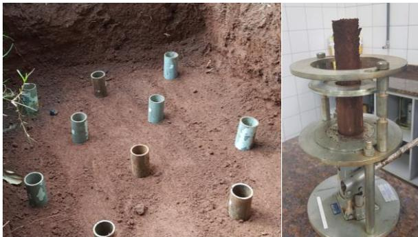
Figura 3. Coleta em campo e extração de amostras.
