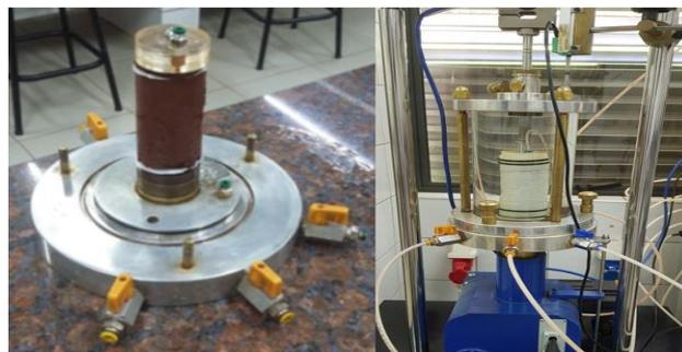
Figura 5. Corpo de prova na câmara de ensaio
