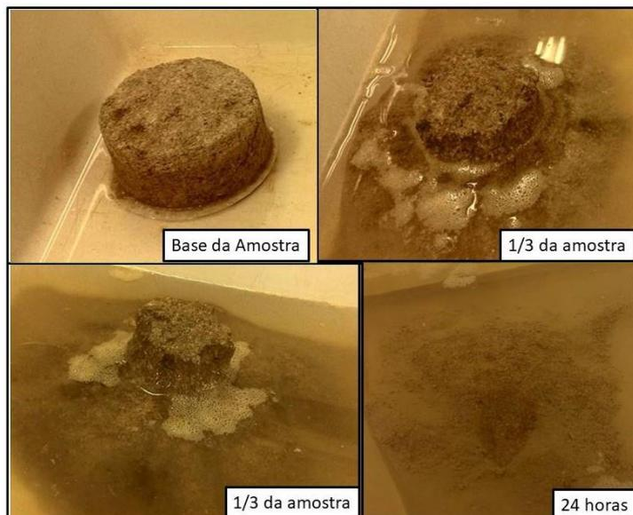
Figura 5. Comportamento da amostra em condição seca ao ar quando submetida à inundação.
