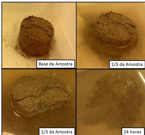
Figura 4. Comportamento da amostra em condição natural quando submetida à inundação.
