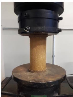
Figura 3. Ensaio de Resistência à Compressão Simples. Fonte: Autoria Própria.
