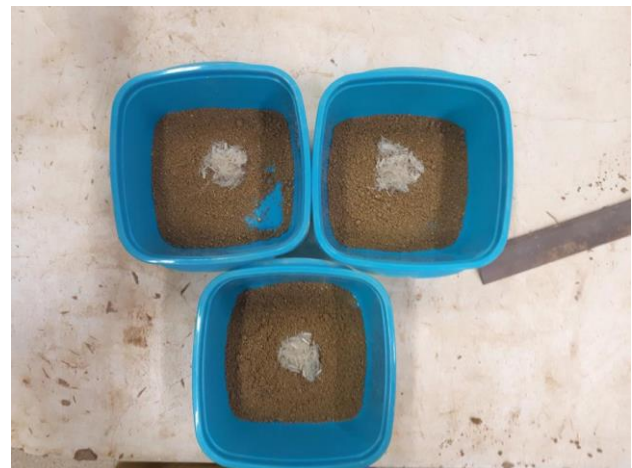
Figura 2. Adição de fibras de curauá ao solo. Fonte: Autoria própria.
