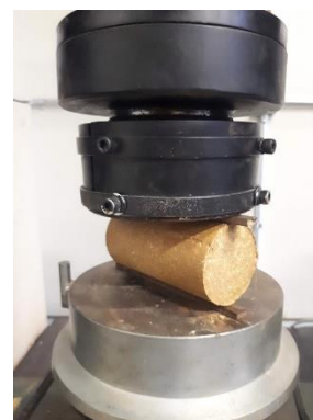
Figura 4. Ensaio de Tração por Compressão Diametral Fonte: Autoria Própria.
