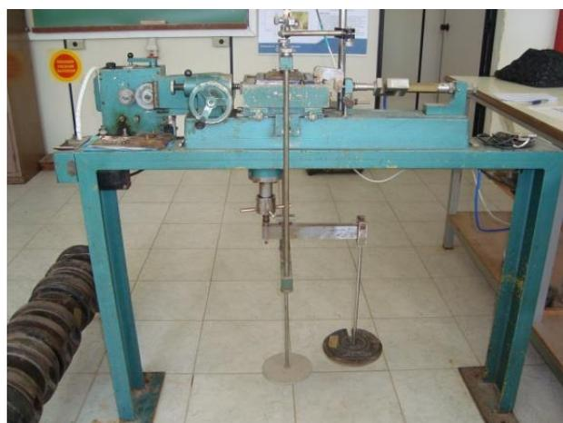
Figura 5. Execução do ensaio de Cisalhamento Direto.
