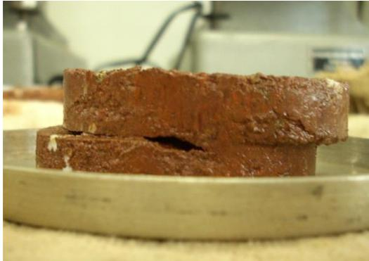
Figura 8: Corpo de prova pós-ensaio sob baixa tensão normal
