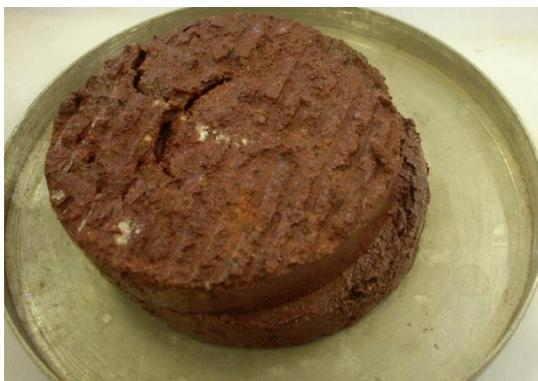
Figura 9: Corpo de prova pós-ensaio sob elevada tensão normal
