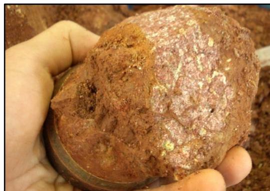
Figura 7: Feições do solo residual observadas durante moldagem de corpos de prova
