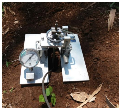
Figura 2: Execução ensaio BST.
