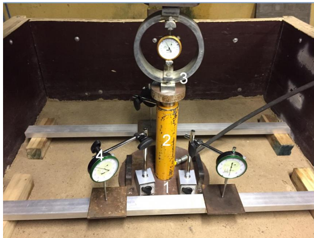
Figura 3. Equipamentos e instrumentação utilizados no ensaio: (1) Placa metálica, (2) Macaco hidráulico, (3) Anel de carga e (4) Relógio comparador.
