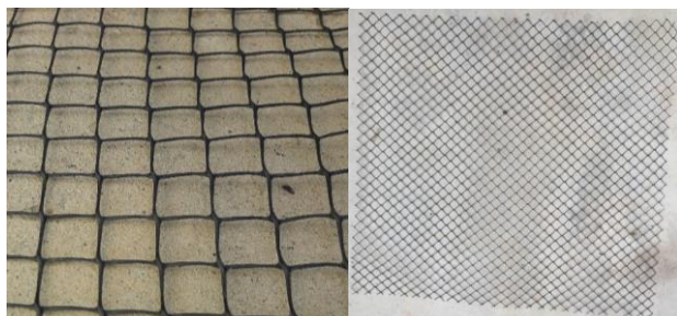
Figura 6 – Tela plástica utilizada como reforço: (a) Vista em detalhes e (b) Visão geral.
