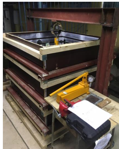
Figura 2. Visão geral da estrutura do pórtico de reação e caixa de ensaios.
