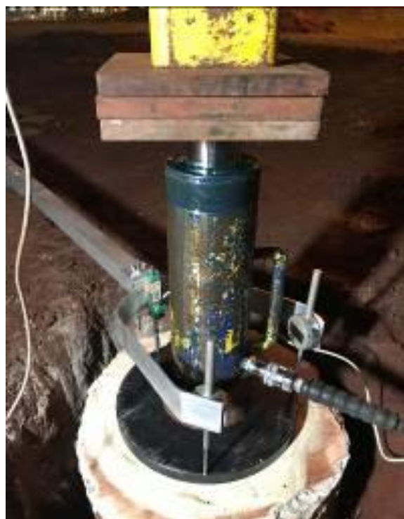
Figura 6: Execução do ensaio de placa na camada
