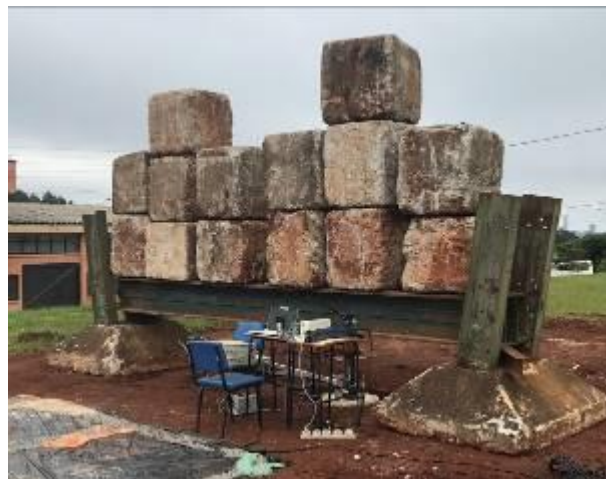
Figura 5: Pórtico de reação com capacidade de 20 tf.
