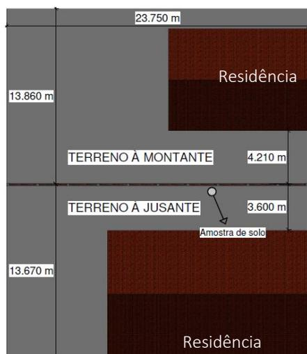
Figura 4. Projeção em planta do muro e áreas adjacentes
