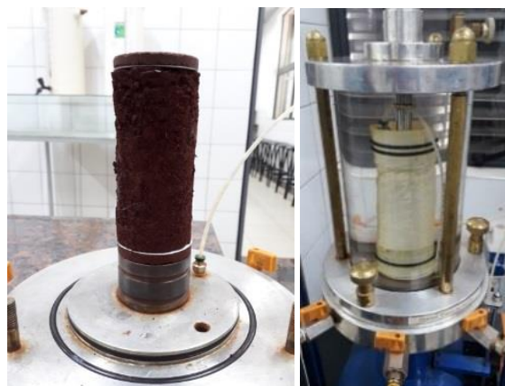
Figura 9. Amostra indeformada na câmara de ensaio
