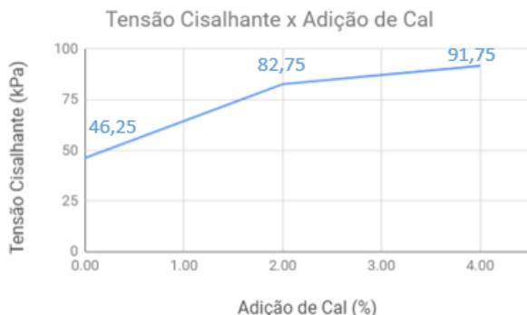
Figura 7. Comparação dos resultados de resistência ao cisalhamento com teores de cal.
