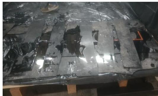
Foto 03 – Sanduíche lubrificado para translação da superfície de ruptura
