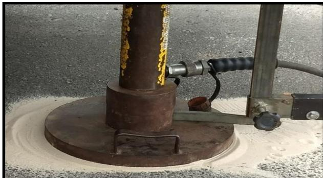
Figura 5. Execução do ensaio de carga com placa.
