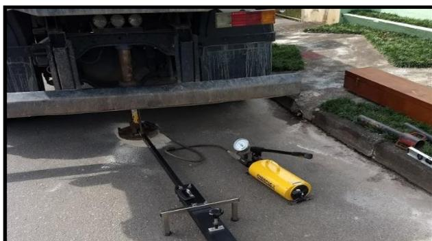
Figura 6. Placa com Viga Benkelman acoplada.
