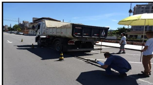
Figura 7. Ensaio com a Viga Benkelman.
