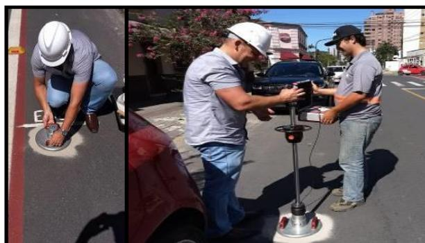
Figura 8. Ensaio de Deflectômetro de Impacto Leve (LFWD)
