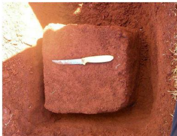
Figura 3. Vista superior do processo de retirada da amostra indeformada. Fonte: Biavati (2017).
