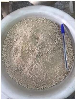
Figura 2. Resíduo de Retificação Cerâmica (RRC) após preparação no laboratório.
