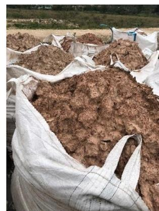
Figura 1. Resíduo de Retificação Cerâmica (RRC) no estado da coleta e após preparação no laboratório.
