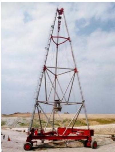
Figura 4. Tripé de Menard usado na compactação dinâmica (Fonte: Hamidi, 2014)
