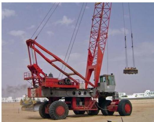
Figura 5. Equipamento de compactação dinâmica com energia de 7 MNm (Fonte: Hamidi, 2014)
