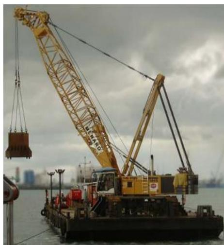
Figura 8. Equipamento de compactação dinâmica *offshore* em plataformas marítimas. (Fonte: Hamidi, 2014)
