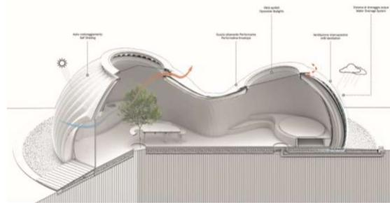
**Figura 14 - Corte longitudinal perspectivado de uma unidade TECLA. Fonte: <https://www.3dwasp.com/en/3d-printed-house-tecla/> Acessado em 24/06/24.**
