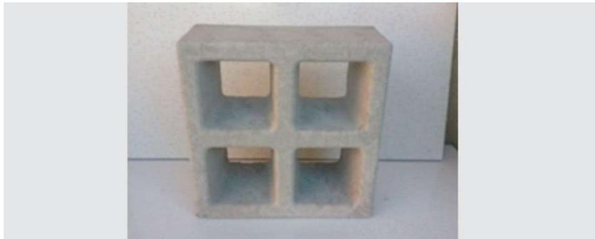
Figura 1: Cobogó produzido a partir do rejeito de granito. Fonte: Aguiar *et al.* (2018).
