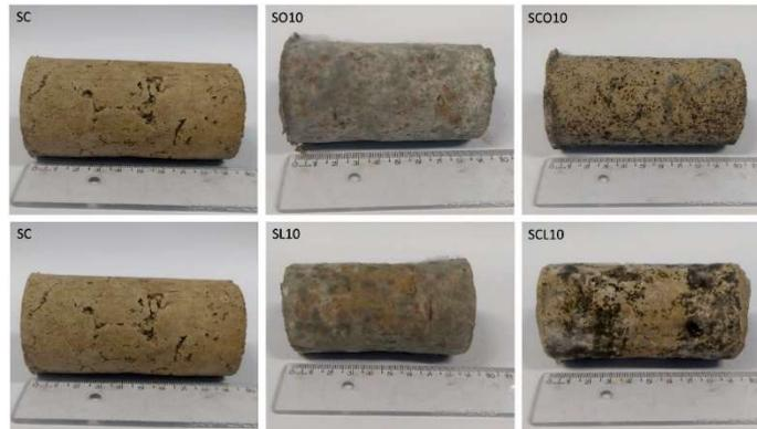
**Figura 5:** Corpos de prova nas composições solo-cimento (SC0), solo-casca de laranja (SO10), solo-cimento-casca de laranja (SC10), solo-casca de limão (SL10) e solo-cimento-casca de limão (SCL10) com tempo de cura de 16 dias.
