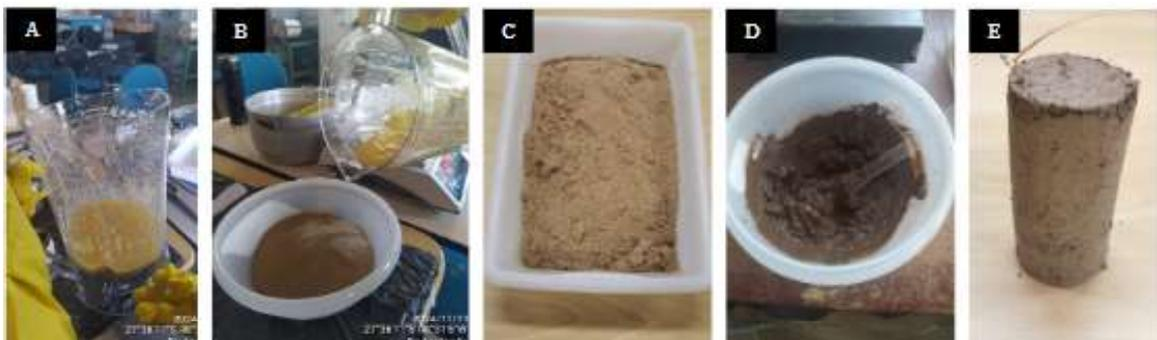
Figura 2: Processamento do bioativo e terra (A, B, C), mistura (D) e corpo de prova obtido (E).
