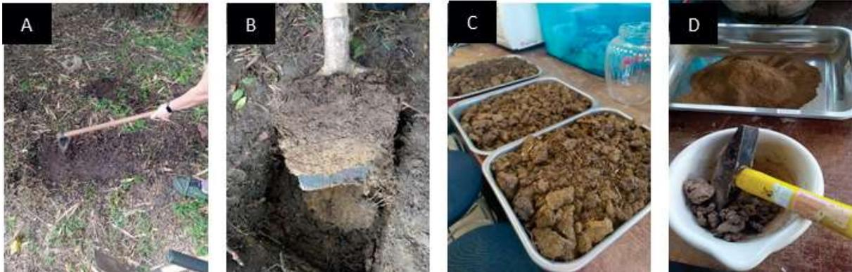
Figura 1: Coleta, secagem e destorroamento da terra
