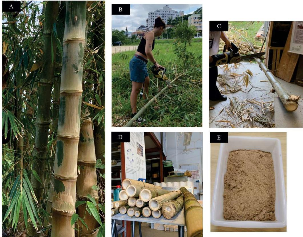
Figura 3: Colheita de colmos de bambus da espécie *Dendrocalamus asper* da área do CultivarQ (A - <https://cultivarq.paginas.ufsc.br/>) – Fazenda Experimental de Bambus – Departamento de Arquitetura e Urbanismo da UFSC. Os colmos foram limpos (B, C) e cortados no laboratório (D) e serragem coletada para confecção dos corpos de prova.
