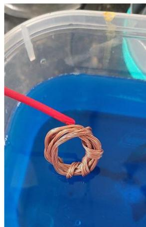
Figura 5: Cobre na solução eletrolítica. Fonte: Autores.
