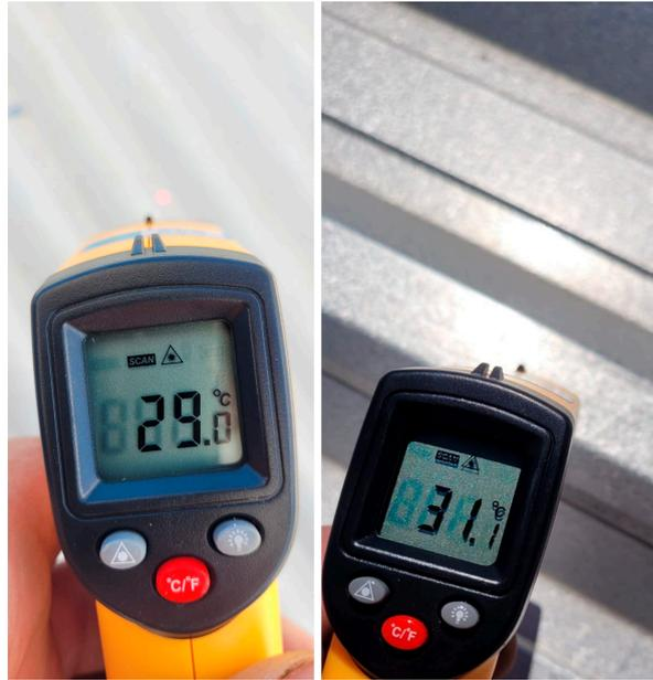
**Figura 9:** temperatura de superfície do galpão 1 (à esquerda) e do galpão 2 (à direita), comparando as áreas com e sem a aplicação da tinta elastomérica. Fonte: elaborado pelos autores.
