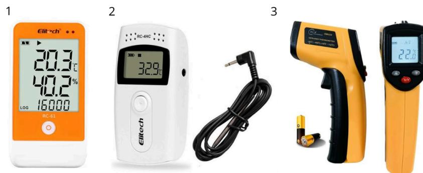
**Figura 5:** *Datalogger* usado nas medições internas(1), *datalogger* utilizado nas medições externas (2) e termômetro de superfície (3). Fonte: Elitech Brasil, 2025.
