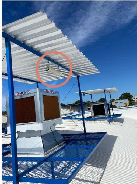
Figura 6: *Datalogger* com Abrigo Higrotérmico instalado. Fonte: autores.
