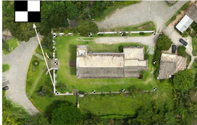
**Figura 9: Exemplo do método de registro com pontos de controle. Fonte: elaborado pelos autores.**
