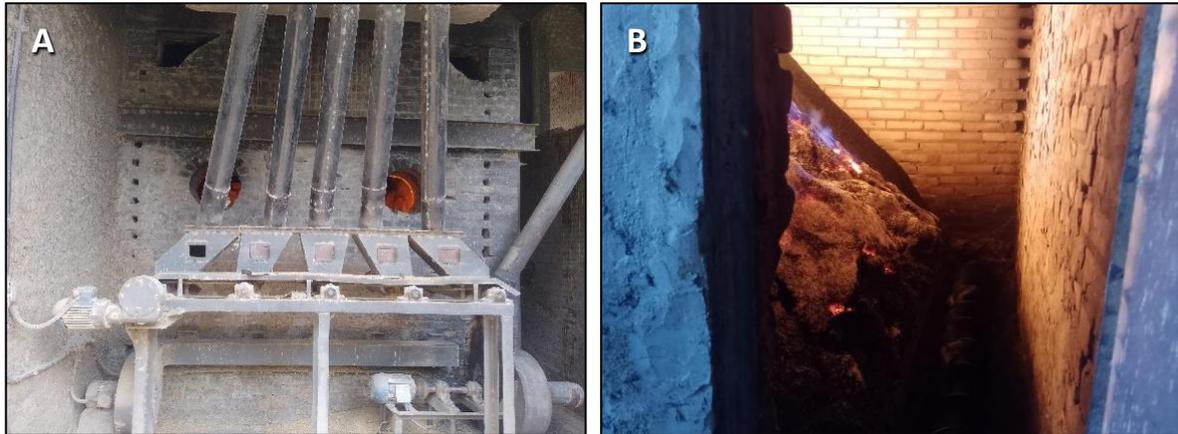
Figura 1 – Processamento da casca de arroz em moinho em Santa Maria – RS: (A) forno de secagem e (B) câmara de queima da casca. Fonte: Autores (2025).
