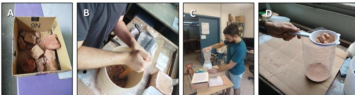
Figura 2 – Processo de moagem da argila: (A) argila seca bruta; (B) trituração grossa; (C) trituração fina; (D) peneiramento. Fonte: Autores (2024).
