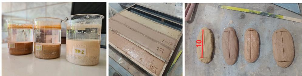
**Figura 11: Testes de decantação (A) ; da caixa (B) ; do biscoito (C).**
