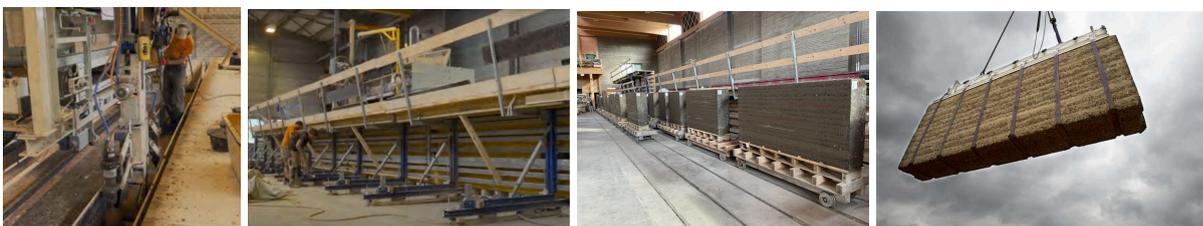
Figura 07: Conceito de manufatura da taipa de pilão mecanizada. Fonte: Lehm Ton Erde.
