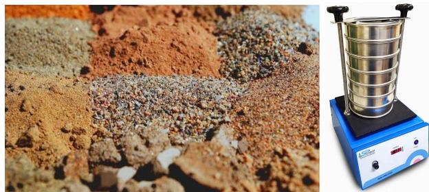
**Figura 04 : Granulometria (esq.) e Agitador eletromagnético (dir.). Fontes: LinkedIn Professor e Geólogo Marcio Leão à esquerda. SPLABOR à direita.**
