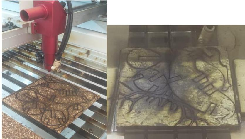
Figura 5: Cortes profundos e leves queimaduras, usinagem com sucesso; Placa queimada, usinagem com falhas.
