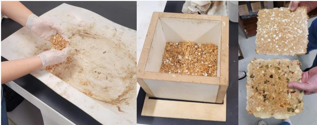
Figura 2: Preparação da mistura; Preparo do colchão para prensagem; Compósitos após prensagem.
