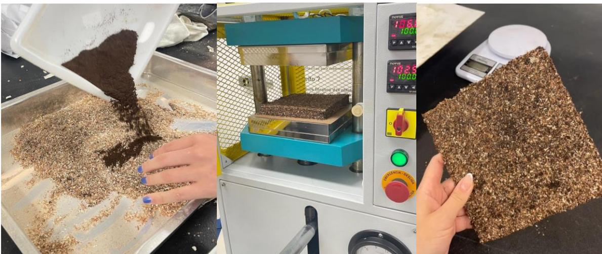
Figura 1: Preparação da mistura; formação do colchão e prensagem; compósito após a prensagem.
