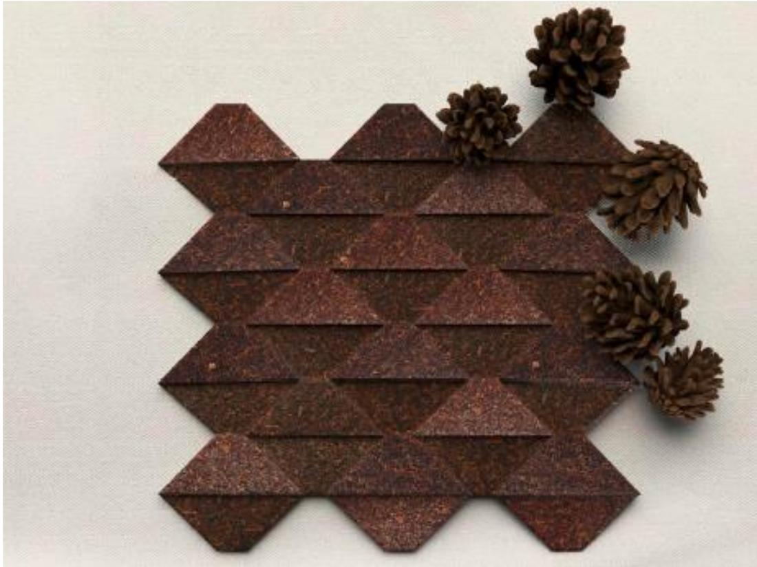
Figura 2: Composição de ecopastilhas à partir dos compósitos de pinha residual. Fonte: elaborado pelos autores.
