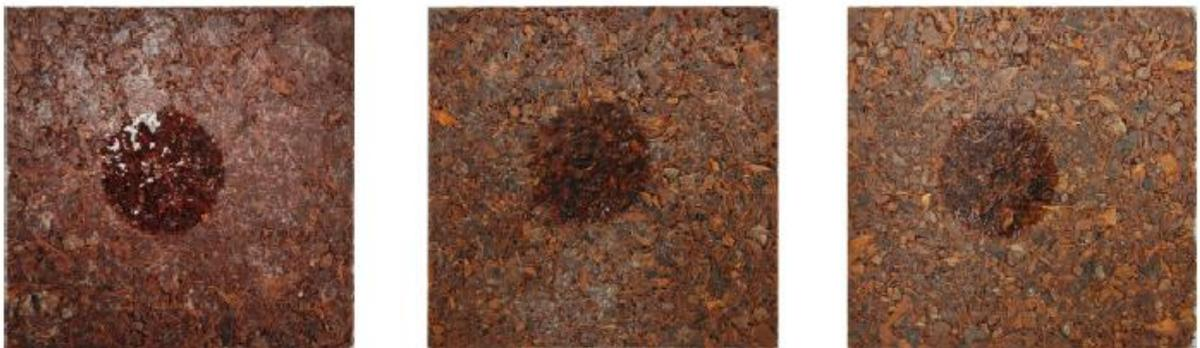
Figura 1: Ensaio de estanqueidade em amostras dos compósitos de pinha residual. Fonte: elaborado pelos autores.
