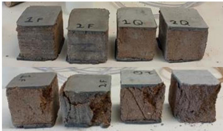
Figura 12: Prismas antes e depois do teste de resistência à compressão Fonte: Elaborado pelo autor
