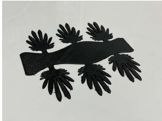
Figura 7: Modelo de superfície lisa impresso com TPU . Fonte: elaborado pelos autores
