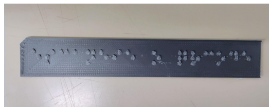
Figura 13: Segundo protótipo da placa braille, impresso em 3D. Fonte: placa e fotografia elaboradas pelos autores.
