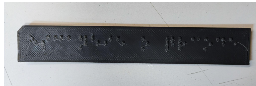
Figura 12: Primeiro protótipo da placa braille, impresso em 3D. Fonte: placa e fotografia elaboradas pelos autores.
