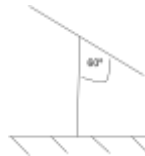
Figura 15: Ângulo de inclinação da placa com seu suporte, como determinado pela NBR9050. Fonte: desenho elaborado pelos autores.
