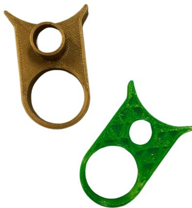
**Figura 4: Adaptador para pincéis/lápis impressos. Fonte: elaborado pelos autores.**
