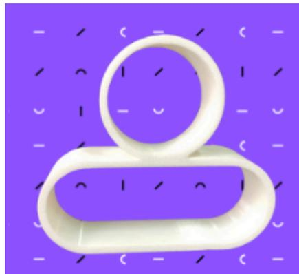
**Figura 9: Adaptador para esponjas impresso. Fonte: elaborado pelos autores.**
