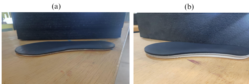
Figura 7: Palmilhas revestidas: (a) Palmilha revestida com camada de PORON© 4701-40 e (b) Palmilha revestida com duas camadas: PORON© 4701-40 e EVA. Fonte: elaborado pelos autores.
