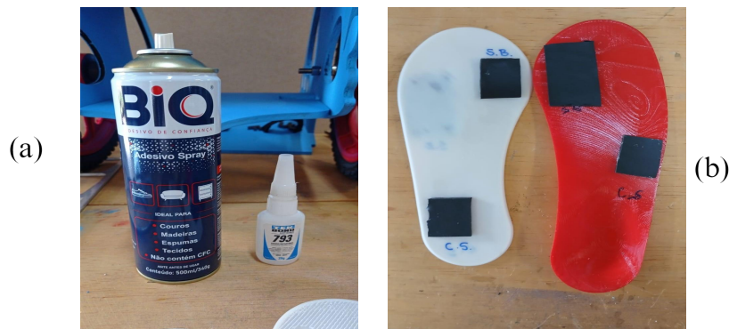
Figura 6: Teste de aderência: (a) Colas adesivas testadas e (b) Palmilhas com teste realizado. Fonte: elaborado pelos autores.
