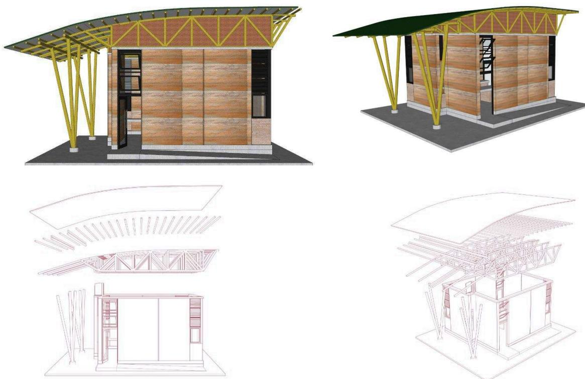
**Figura 6: Maquete virtual da Casa-Laboratório com a previsão futura da cobertura com estrutura em bambu e telhas termo acústica de aluzinco. Fonte: autores.**
