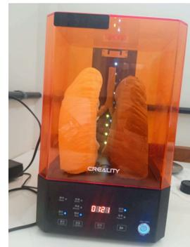
**Fig. 13:** Cura das junções em máquina UV.
