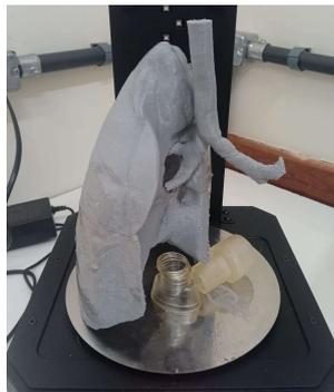
**Fig. 12:** União da traqueia e um dos pulmões com aplicação de resina líquida.
