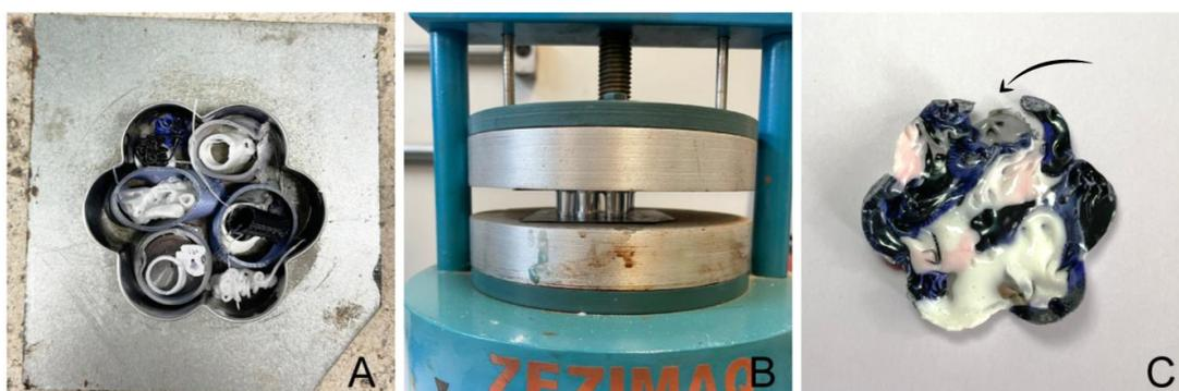
**Figura 7:** Teste 4, onde (A) são os resíduos, (B) prensagem, e (C) o resultado. Fonte: Autores (2025).
