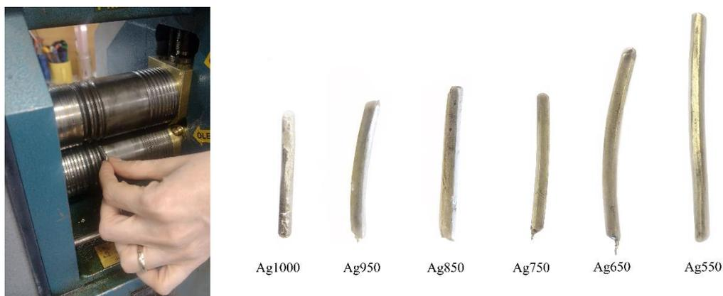
Figura 2: Processo com laminador elétrico e chapas resultantes. Fonte: Autores (2025).
