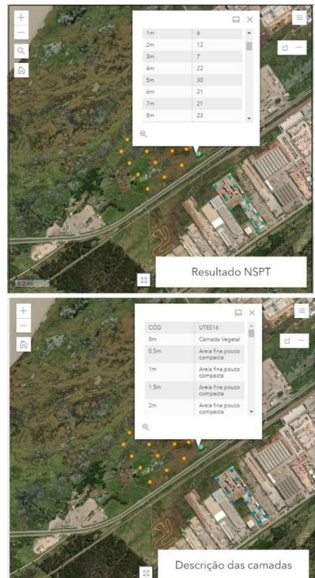
Figura 5. Aplicativo que permite visualizar simultaneamente os valores de  $N_{SPT}$  e descrição de compactidade/consistência ao longo de um furo de sondagem.
